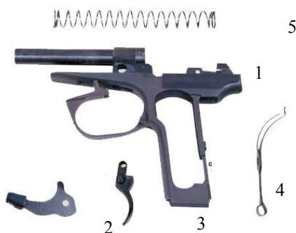
Рисунок 2.7 – Рамка зі стволом та спусковою скобою: 1 – загальний вигляд рамки; 2 – затворна затримка; 3 – спусковий крючок; 4 – бойова пружина; 5 – зворотна пружина
