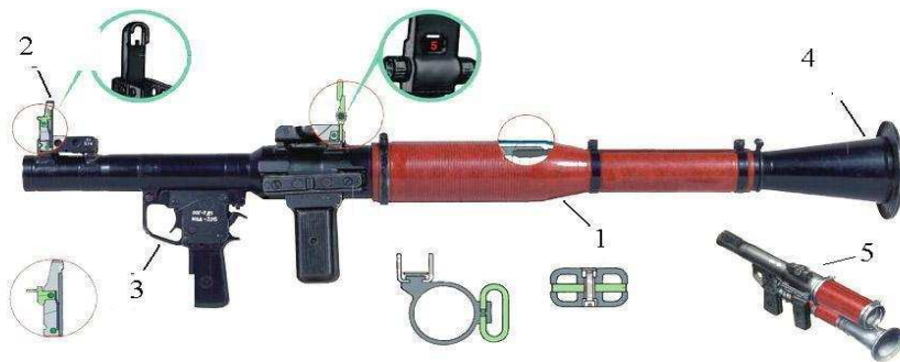
Рисунок 2.13 – Основні частини і механізми РПГ-7: 1 – труба; 2 – механічний (відкритий) приціл; 3 – ударно-спусковий механізм; 4 – розтруб; 5 – РПГ-7Д складений
