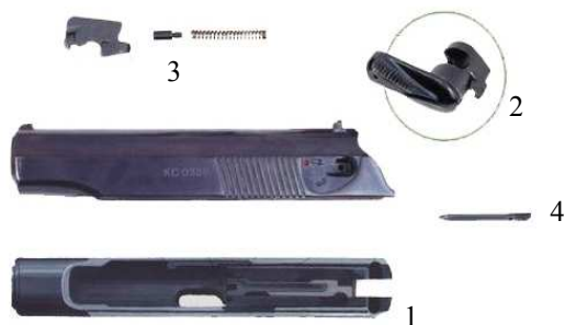
Рисунок 2.6 – Затвор: 1 – загальний вигляд затвора; 2 – запобіжник; 3 – викидач; 4 – ударник
