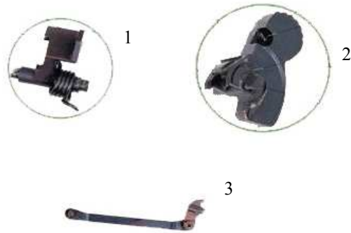
Рисунок 2.8 – Елементи ударно-спускового механізму: 1 – шептала з пружиною; й2 – курок; 3 – спускова тяга з важелем взводу
